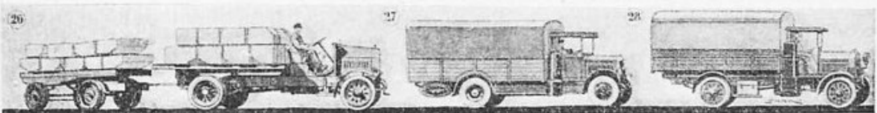
26. Камневоз с прицепной платформой на 10 м.
